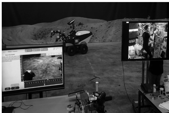
图4 METERON 遥操作模拟月球车抓取探测
