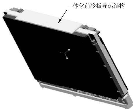
图8 一体化前冷板导热结构
